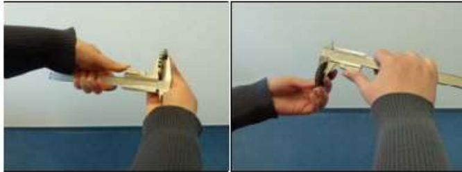
Bild 1/2: Rechtshänder-Schieblehre: Handhabung bei Links- bzw. Rechtshändigkeit (Fotos: C. Kohlhöfer, BGHM)
