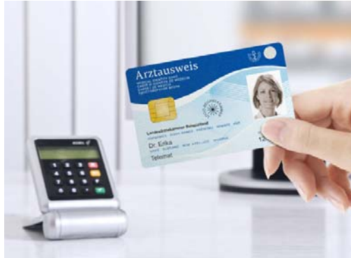
Der elektronische Arztausweis ermöglicht das digitale Signieren und Verschlüsseln von Dokumenten.
